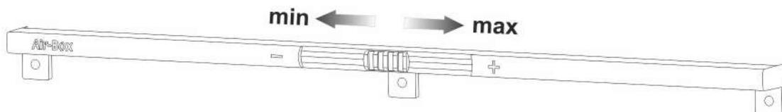
Во избежание повреждения клапана не рекомендуется разбирать его и прикладывать чрезмерные усилия при регулировке режимов работы.
