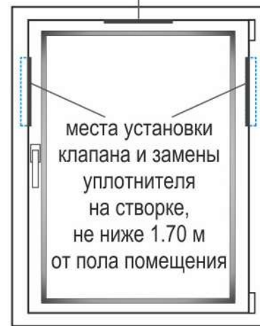
Вариант монтажа с повышенной звукоизоляцией рис.1б
